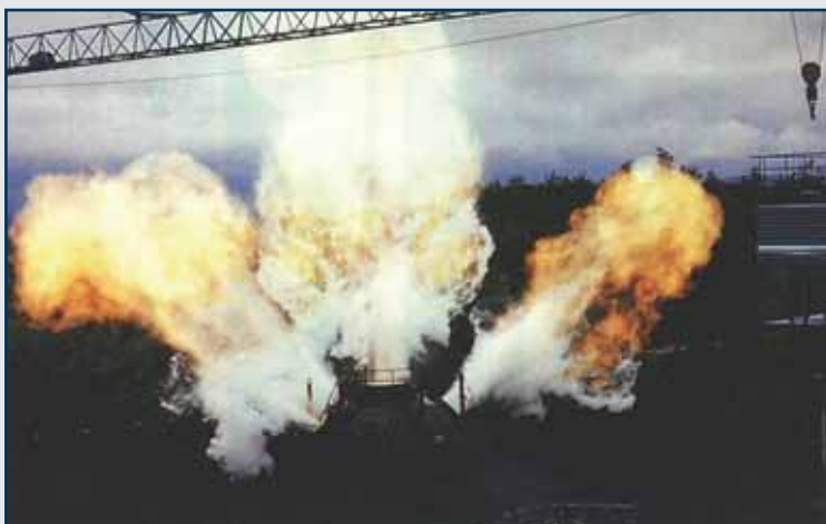
Explosiedrukontlastingstest in een 250 m 3 vat (Zwitserland)
